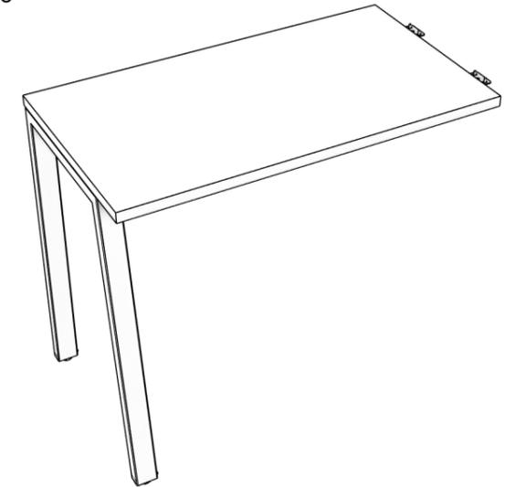
Posicione a mesa auxiliar à mesa reta para fixar as chapas de conexão.
